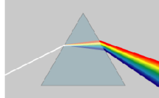
Şəkil 1. İşıq şüaları üçüzlü prizmadan keçərək sınması və prizmadan çıxarkən başlanğıc istiqamətlərindən sapması.
